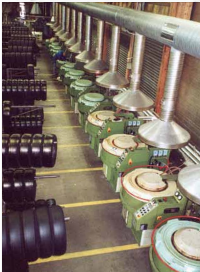
Pinnoitusmuottirivistö Kestilän tehtaalta.
